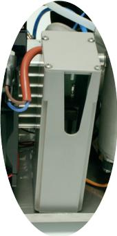
*4 Schrauben vom Gehäusedeckel des Keramikelements lösen.*
